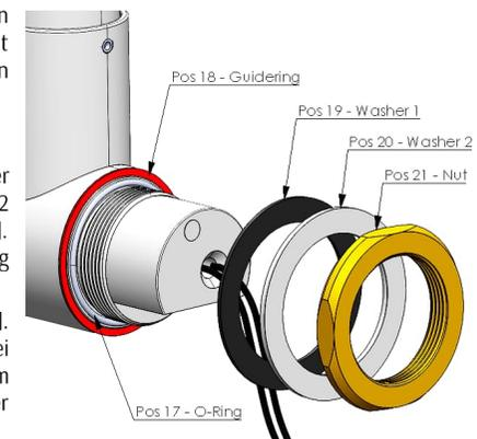
Anschließend ist die Armatur mit dem O-Ring durch den Lochkreis zu stecken und das eben entfernte Montageset aus Pos 19-21 wieder zu montieren. Achte bitte drauf dass der O-Ring nicht verrutscht.
