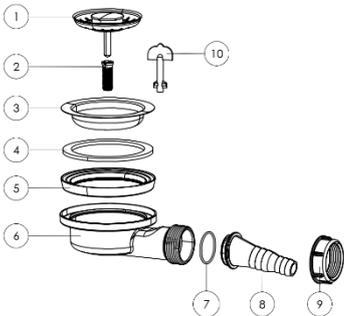
Jeder Queensize Camper Spüle liegt unser spezielles Ablaufset bei, welches extrem wenig Bauhöhe hat. Damit verbindest du die Spüle mit einem 19mm bzw. 25mm Wasserschlauch (Innendurchmesser), oder nutzt das optional erhältliche Siphon Set oder den Flex-Schlauch!
