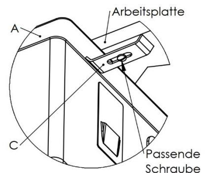
Bei Verwendung der Klammern ist auf ein mögliches Verrutschen der Spüle während der Montage zu achten, oder wenn die Silikondichtung noch nicht ganz ausgehärtet ist! Eine Silikondichtung ist nicht Teil des Paketes. Wir empfehlen handelsübliches Küchen-Silikon oder Sanitär-Silikon.
